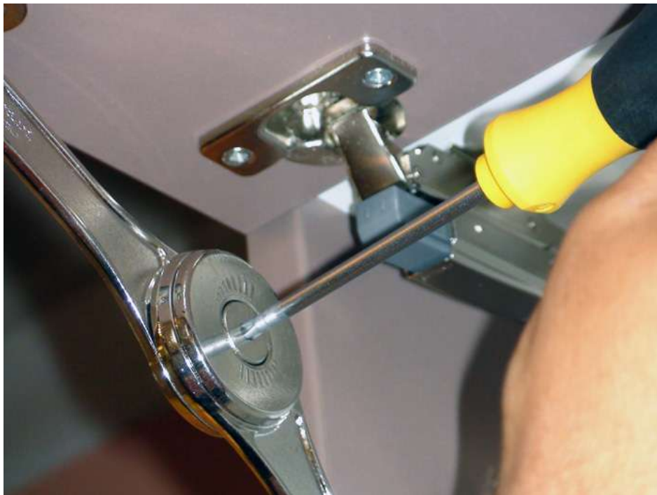
Bild 17. Scherenklappenbeschlag Bremse einstellen.
