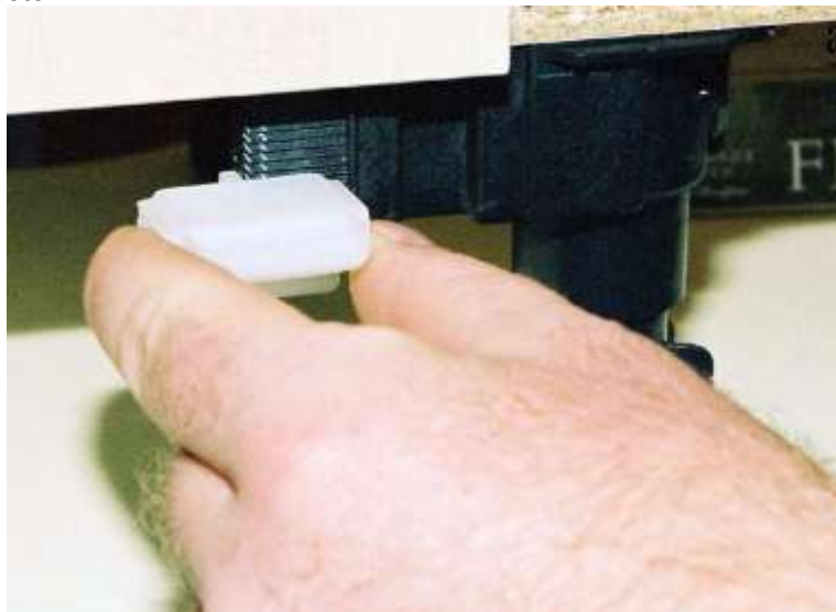
Bild 13. Clips in Richtung Sockelfuß verschieben.
